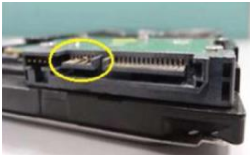
Uszkodzone piny SATA
