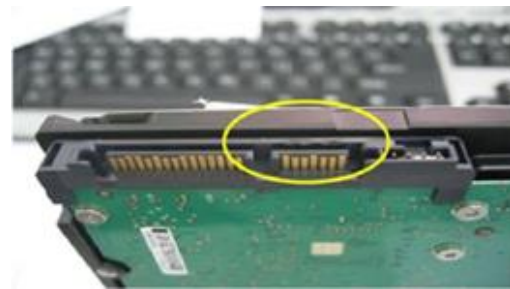
Wyłamana bądź uszkodzona część złącza SATA
