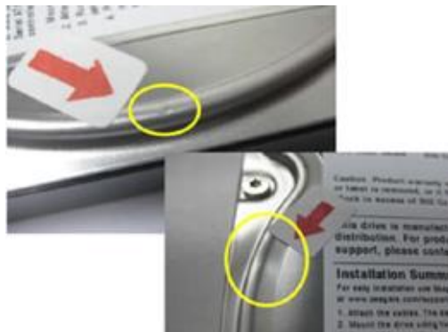
Obicia wgniecenia obudowy dysku
