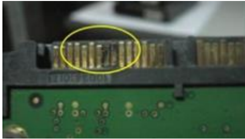
Wypalony element elektroniczny przy złączu zasilającym
