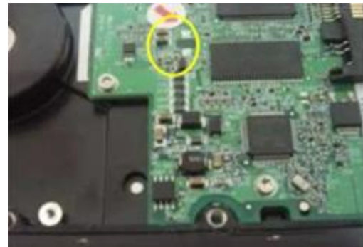
Płyta PCB z uszkodzonym złączem przesyłu danych
