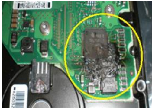
Widoczne ślady spalenia płyty PCB
