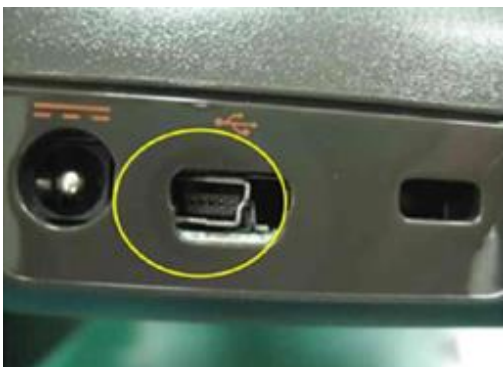
Uszkodzony mechanicznie port USB
