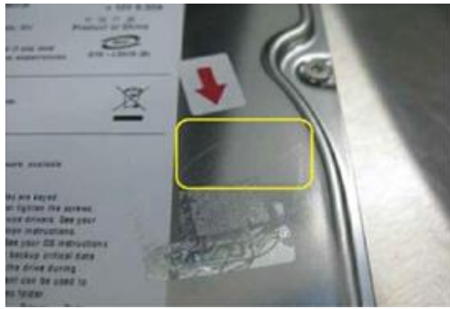
Obicia wgniecenia obudowy dysku
